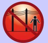
**Ne restez pas sous les fils électriques ou autres éléments pouvant s'effondrer**
